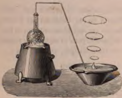
Fig. 122. — Préparation de l'hydrogène phosphoré gazeux.
